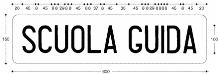
Figura IV 4 Art. 334 CONTRASSEGNO ANTERIORE E POSTERIORE PER I VEICOLI DELLA CATEGORIA M1 (dimensioni in millimetri)
